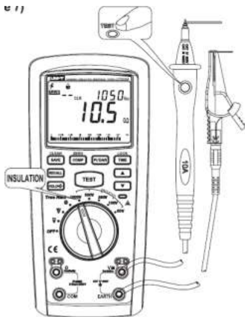
Fig. 7 Măsurarea rezistenței de izolație
