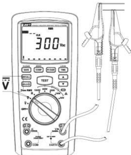
Fig. 5 Masurarea tensiunilor DC
